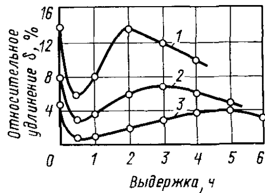
Рис. 116. Изменение относительного удлинения титана и его сплавов в зависимости от выдержки при температуре пайки:
