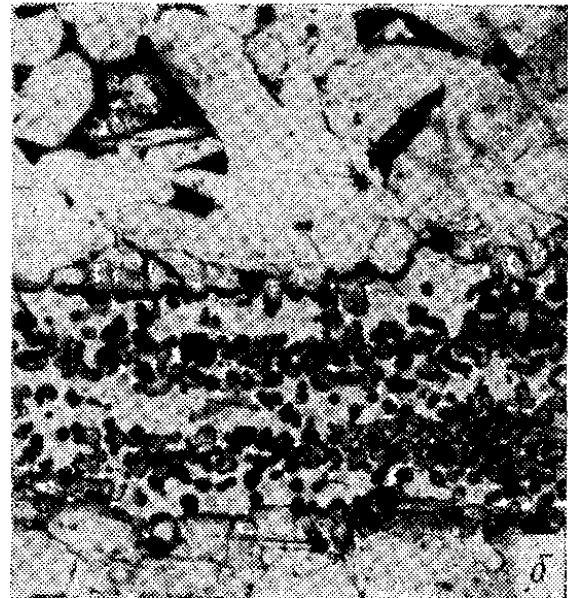
Рис. 107. Окисная пленка в зоне спая при пайке горячекатанной стали Ст3 медью в среде водорода, \times 200 (а) и в объеме шва при пайке предварительно окисленного армко-железа в среде водорода, \times 600 (б)
